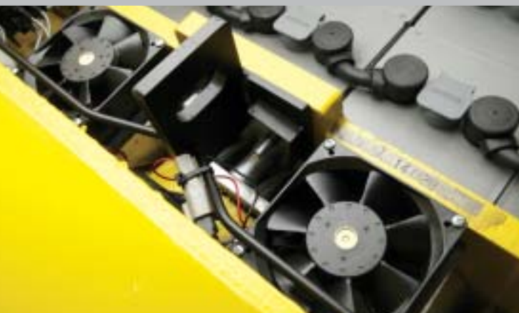
Les ventilateurs à commande thermique (TCF™) permettent d'économiser la batterie.
